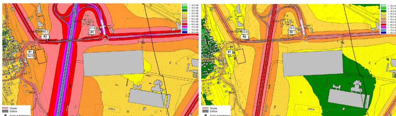
Figura 22 – Mappa degli isolivelli acustici calcolata a 4 metri di altezza dal suolo (Scenario di Progetto) – A sinistra Periodo diurno, a destra Periodo notturno
