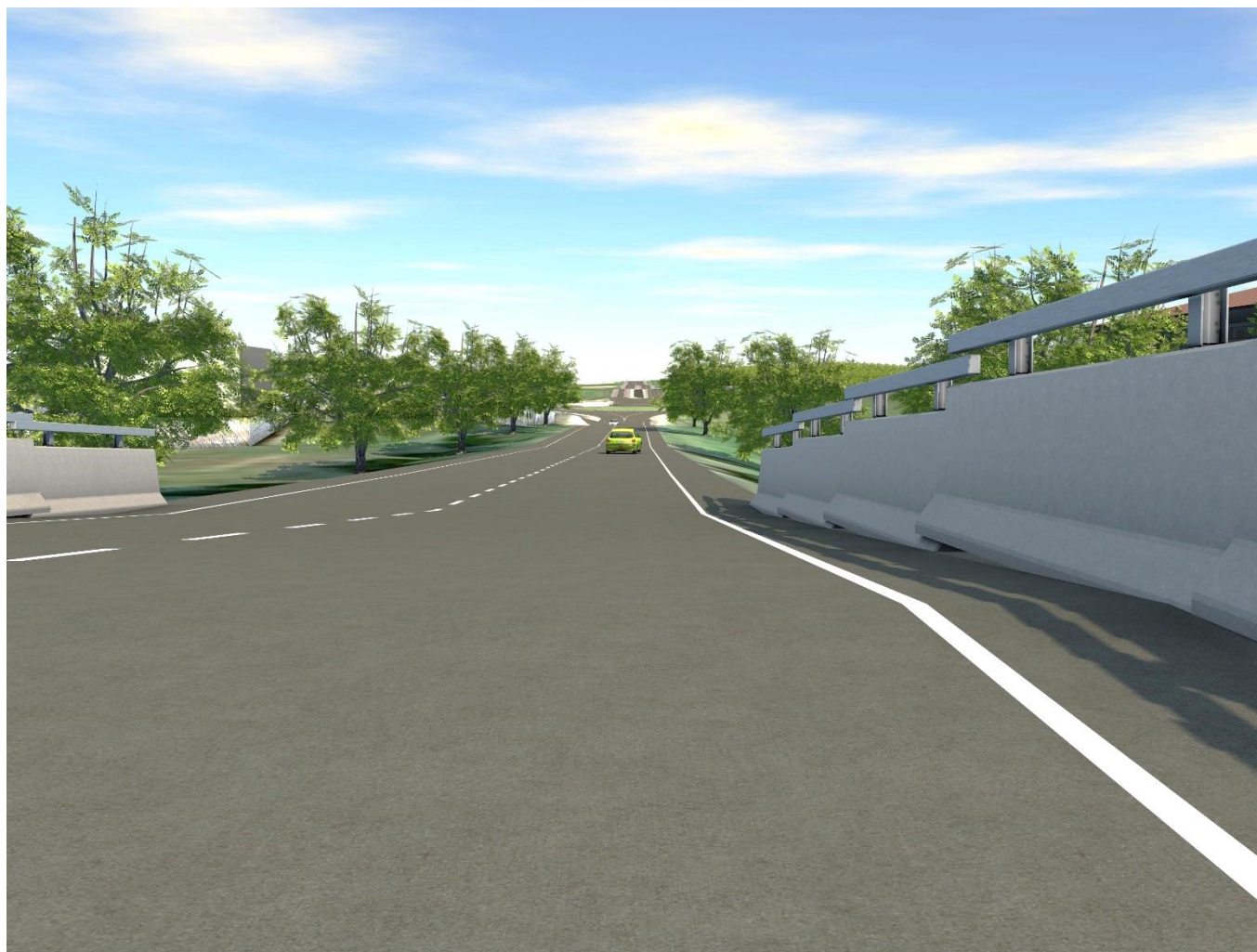
Figura 65 – Verifica della distanza di visibilità per l'arresto – Visibilità del tracciato piano-altimetrico – Modello Infraworks
