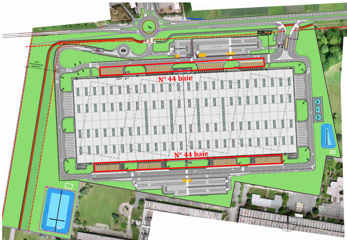
Figura 4-5 – Stralcio del planivolumetrico di progetto. In rosso sono evidenziate le posizioni delle baie di carico/scarico.
